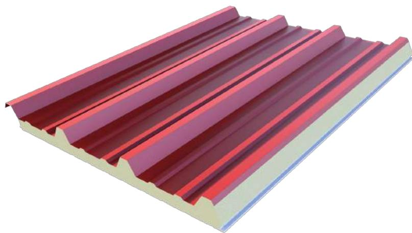
Los paneles termoaislantes **TAF 1000** de **CALAMINON** están compuestos por dos láminas de Acero Aluminizado ASTM A792, unidas por un núcleo de espuma rígida de Poliuretano (PUR) o Poliisocianurato (PIR) de alta densidad. Al ser producidos en línea continua aseguran homogeneidad del núcleo ofreciendo un mejor aislamiento térmico y resistencia estructural.
