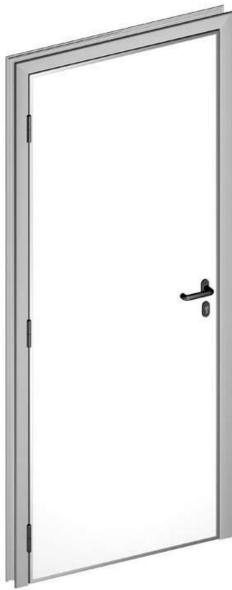
Puertas tipo oficina semi-aisladas con una o dos hojas con marco telescópico modular en aluminio anodizado, hoja compacta de 40 mm de espesor recubierta en lámina metálica plastificada, bastidor perimetral en aluminio anodizado y aislamiento en poliuretano de alta densidad.
