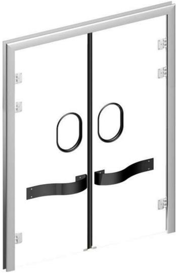
Las puertas semi-aisladas Vaiven se producen con una o dos hojas con marco modular en aluminio anodizado. La estructura de la hoja es compacta de 40 mm de espesor con recubrimiento, bastidor perimetral en aluminio y aislamiento en poliuretano de alta densidad. Las bisagras son en material plástico compuesto con apertura en ambas direcciones y sistema de retención a 90°. Cada hoja cuenta con un mirilla ovalada en lexan.
